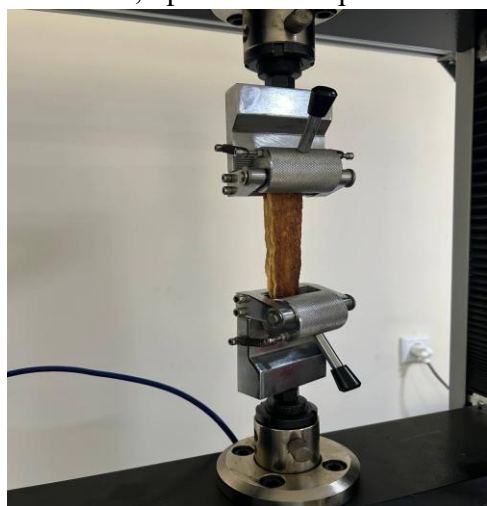
Рис. 1. Определение прочности на Рис.2. График прочности на растяжение. растяжение.
