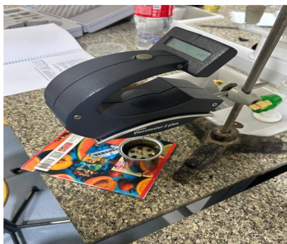
Рис. 3. Определение вязкости на приборе «Viskozimetr HAAKE Viscotester 2 plus».
