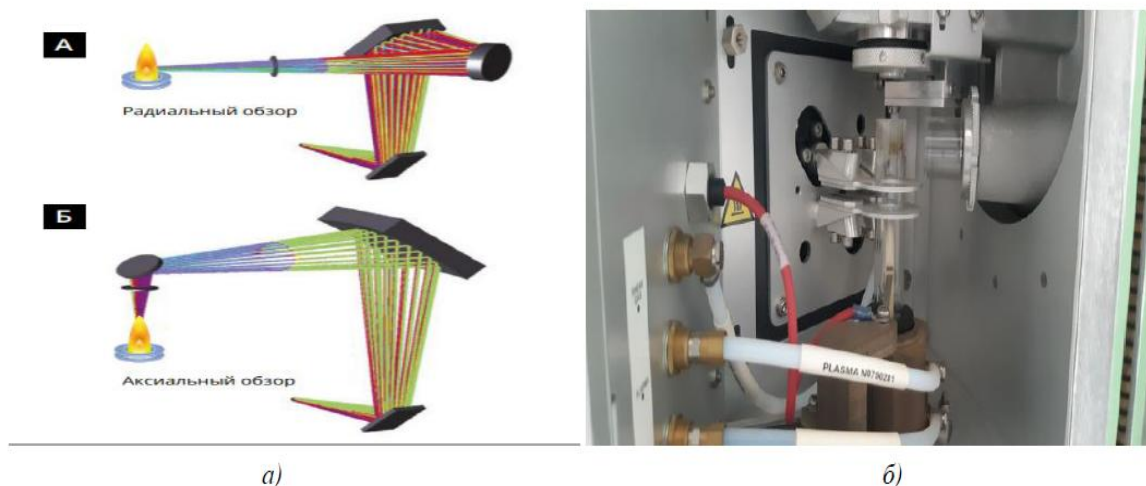
Рисунки 1. Радиальный (а) аксиальный (б) обзоры плазмы
