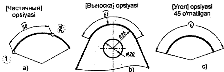
8.12-rasm. Частичный, Выноска va Угол opsiyalaridan foydalanib qo'yilgan yoyning uzunliklari.
