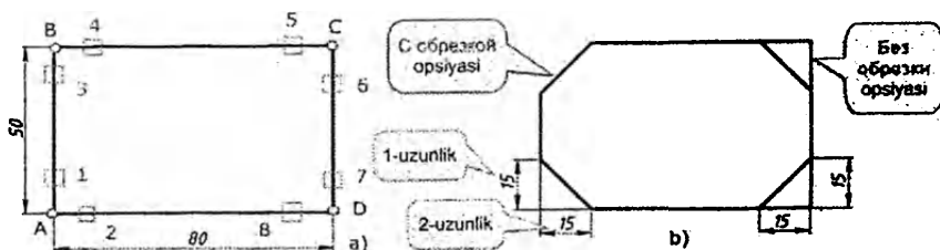
4.52-rasm. С обрезкой и Без обрезки opsiyalaridan foydalanib chizilgan faskalar.
