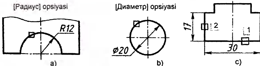
8.25-rasm. Радиус va Диаметр opsiyalaridan foydalanib yoy va aylanaga o'lcham qo'yish jarayoni.
