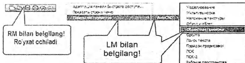
2.14-rasm. «Объектная привязка» asboblarni panelini o'rnatish tartibi.
