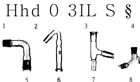
2-rasm: 1 - yassi shliflar; 2 — konussimon shliflar; J — sharsimon shliflar; 4 - ulanadigan qismlar; 5, 7 - haydashda kolba bilan sovutgich ulanadigan shliflar; 6 - quritish uchun ishlatiladigan shlifli xlor kalsiyli nay; 8 - sovutgich bilan yig'gich idish ulanadigan shlifli alonj
