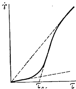
Рис. 90. Полная реологическая кривая тиксотропного материала
