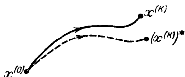
Рис. VII-4. Траектории процесса в фазовом пространстве, соответствующие оптимальному (сплошная линия) и неоптимальному (пунктир) управлениям.
