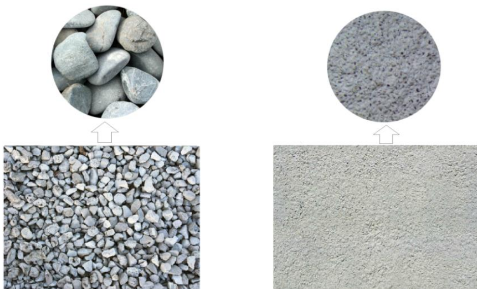
3.2-rasm. Tosh (chapda) g‘ovaklari yirik bo‘ladi va sement (o‘ngda) g‘ovaklari ko‘zga ko‘rinar-ko‘rinmas bo‘ladi.
