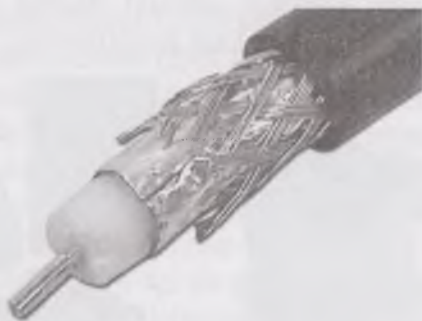
1.9.3-rasm. Koaksial kabel
