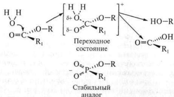
Рис. 20. Реакция гидролиза сложного эфира карбоновой кислоты и структура фосфата — стабильного аналога переходного состояния
