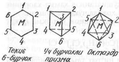
XI.1-рasm. Координацион сони 6 га тенг бўлган марказий атом учун лигандларнинг фазовий жойлашиши мумкин бўлган геометрик ҳолатлар.
